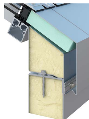
montáž na rám z ocelového plechu
