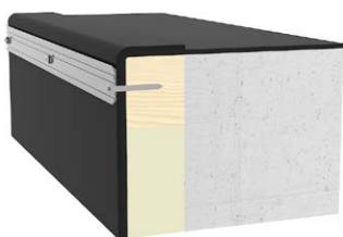
Montáž na betonový okraj
